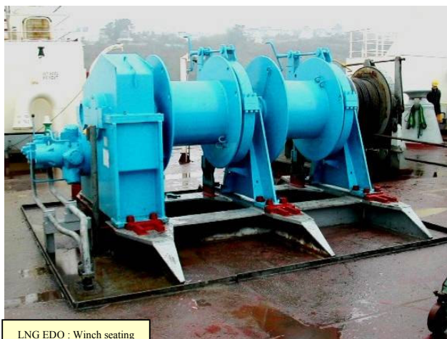
LNG EDO: Winch seating
